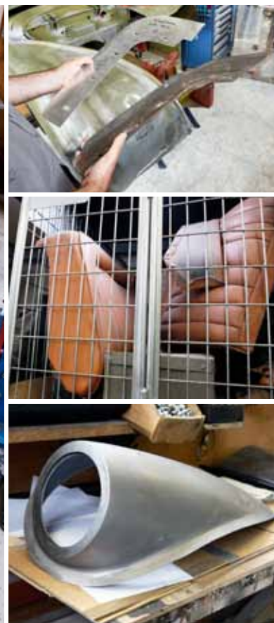
Nicht mehr rettbare Teile müssen reproduziert werden. Die originale Innenausstattung wartet hinter Gittern auf die Restauration. Der Scheinwerfertopf ist ein Neuteil.
