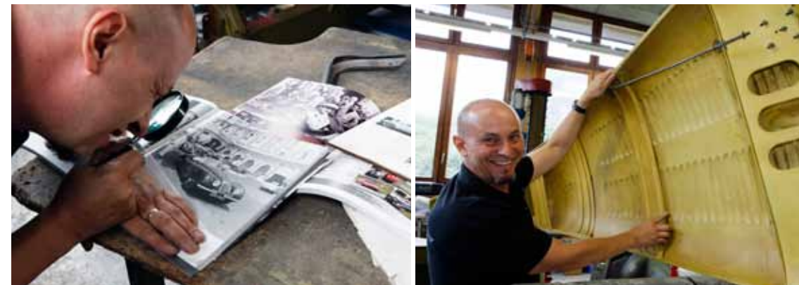
Dönni auf Spurensuche: Die Schlitzlöcher wurden vor Montage der Querstreben angebracht. Das konnte nur das Werk.
