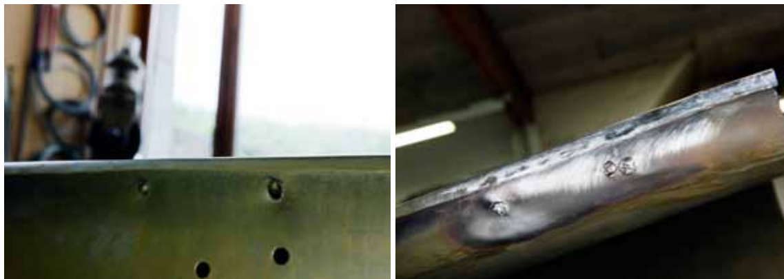
Die Schraublöcher der Riemenhalter am Kotflügel sind innen gut zu sehen (li). Aussen wurden sie sauber verzinkt und kamen erst nach Ablaugen des Lacks wieder zum Vorschein (re).
