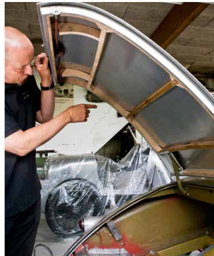
Der Heckdeckel musste restauriert werden, die Spriegel aus Buchenholz wurden soweit wie möglich erhalten.
